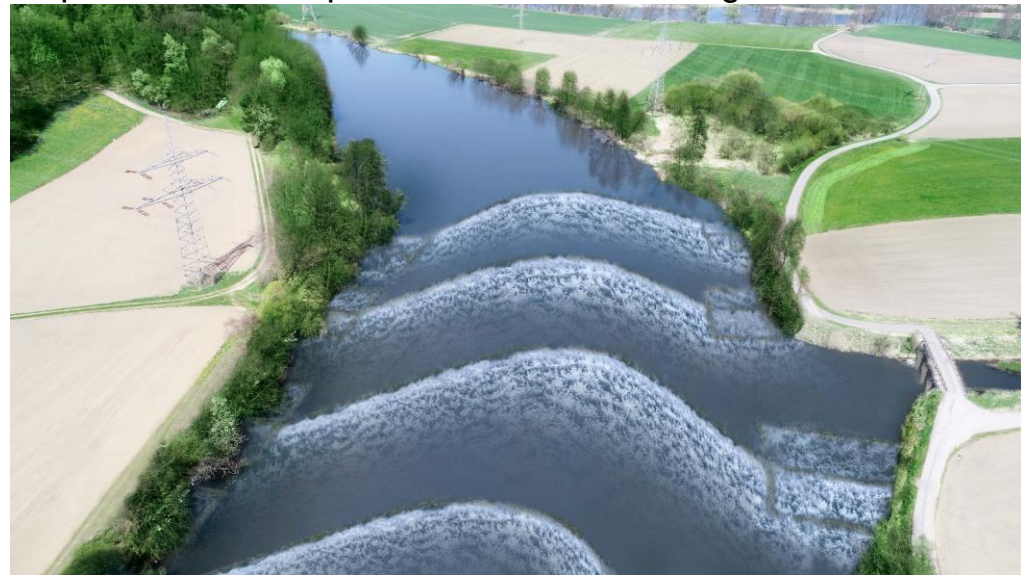
Geplante raue Rampe mit mehreren Steinriegeln
